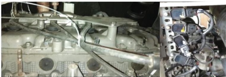
Hình 3. Nắp máy sau khi lắp bugi và dây cao áp
